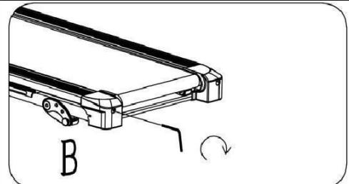
In timp suprafata de alergare se slabeste. Pentru a o strange, rotiti surubul de ajustare drept si stang o tură in sensul acelor de ceas si verificati tensionarea suprafetei de alergare. Continuati acest proces pana cand banda este stransa corespunzator. Atentie! Strangeti ambele suruburi in mod egal! Vezi figura C.
