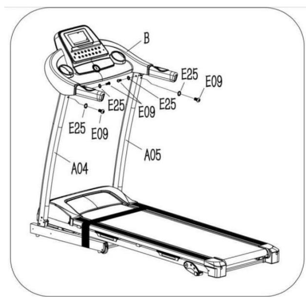
Utilizati cheia (B08) surubul M8\*15 (E09) saiba (E25), pentru a fixa calculatorul (B) pe cei doi stalpi (A04, A05).
