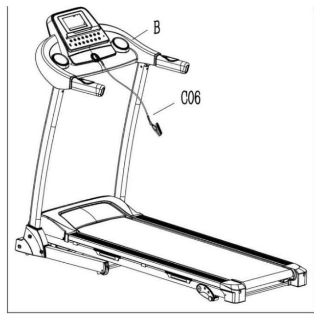
Inainte de alergare, innserati cheia de siguranta (C06) in zona magnetica de pe consola (B) si fixati clipsul (C06) la imbracaminte.
